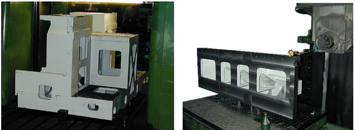
Abb. 5 Fertigbearbeitung beim Innovationspartner Heidenreich & Harbeck Casting GmbH (links: Sockel, rechts: Oberteil)
