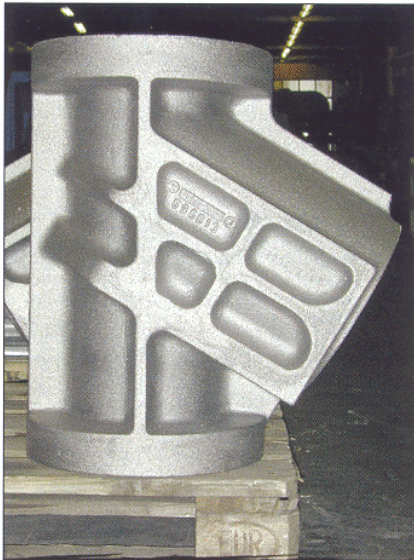
Bild 4: Rohgußteil Armaturengehäuse (Foto: Heidenreich & Harbeck AG Mölln)
